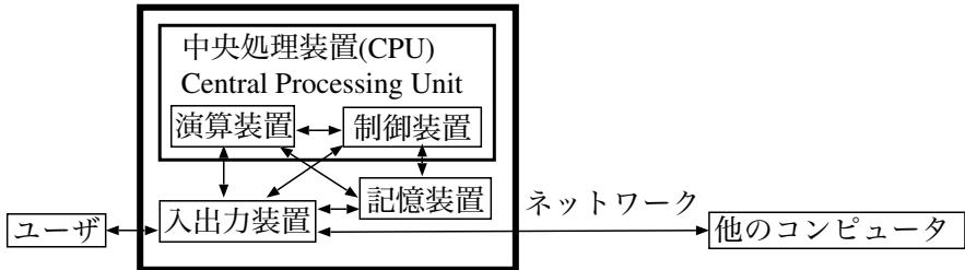
入出力装置 データを入力し出力するための装置です。これを通じて人がコンピュータとやり取りします。
